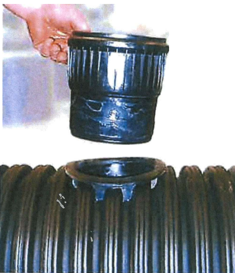
(montaggio del manicotto di collegamento)
